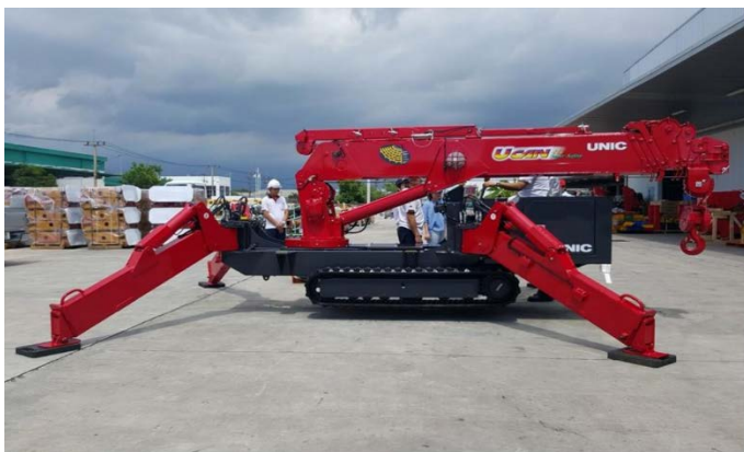
Figure 2: Mini Crawler Crane
