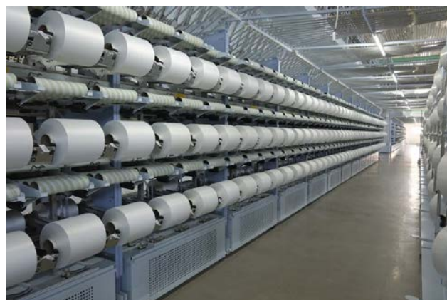
Hình 2: Dàn máy DTY vận hành thử
